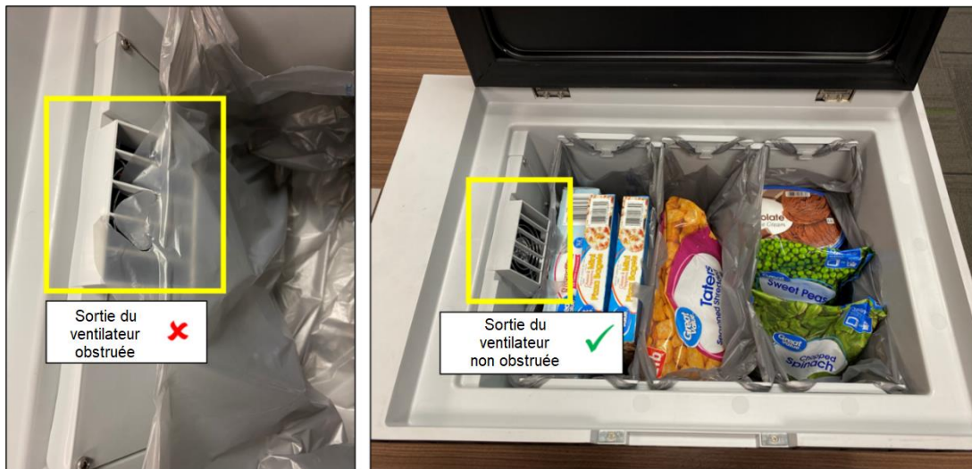
Figure 5 : Comparaison du F451 avec la sortie du ventilateur obstruée (gauche) et non obstruée (droite)
