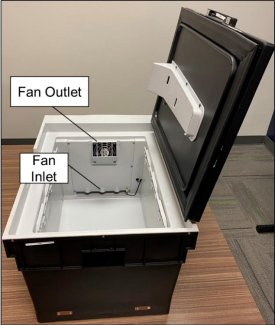
Figure 4: F451 fan outlet and fan inlet
