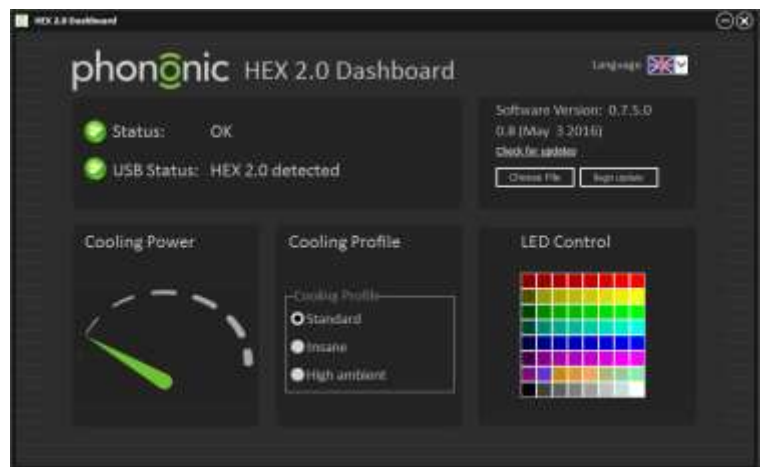
Figure 1 - Le tableau de bord de l'application du HEX 2.0 vous permet de sélectionner le profil de refroidissement, changer de couleur la LED, obtenir et mettre à jour votre firmware et de surveiller la puissance de refroidissement
