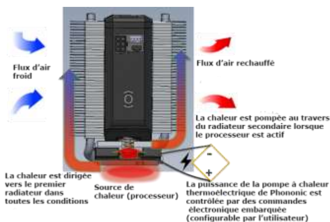
Figure 1 – Avec le design Actif-Passif du HEX 2.0 la pompe ne peut pas abaisser la température de la base en dessous l'ambiante car la chaleur de l'air ambiant sera redirigée vers la base.
